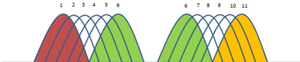
Como puede observarse en la imagen, el canal 1 se superpone con los canales 2, 3, 4 y 5, y por tanto los dispositivos que emitan en ese rango de frecuencias pueden generar interferencias. Lo mismo ocurre con el canal 6 y los canales 7, 8, 9 y 10.
